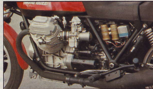
Geringe Baubreite: Der 90°-V-Motor. Die beiden Vergaser sind an gebogenen Stützen nach innen verlegt. Im Rahmendreieck (rechts) ist ein großer Teil der Elektrik.
