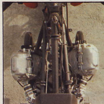
Geringe Baubreite: Der 90°-V-Motor. Die beiden Vergaser sind an gebogenen Stützen nach innen verlegt. Im Rahmendreieck (rechts) ist ein großer Teil der Elektrik.
