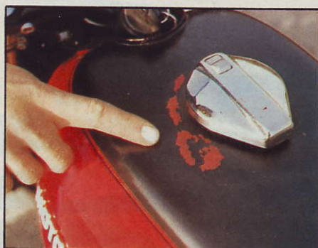
Schon nach kurzer Zeit löste sich der Lack der Tankoberfläche.
