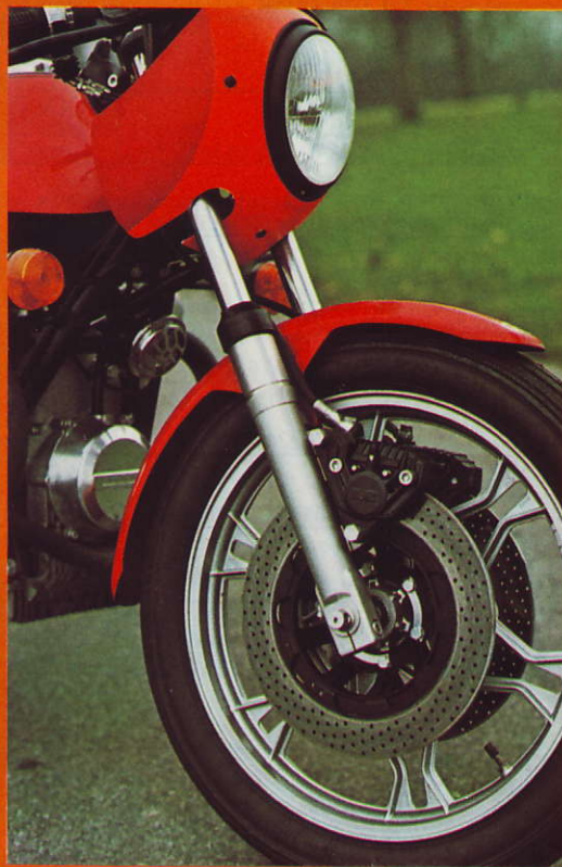
Een verbeterde telescoop, gegoten lichtmetalen wielen en lichtmetalen schijven.
