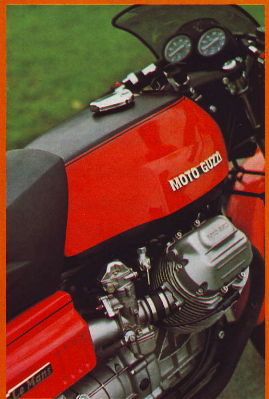
De 81 pk worden gevoederd door twee 36 mm Dell'Orto carburateurs.
