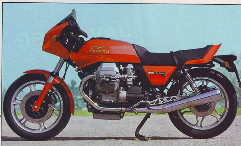
**Schnelle Kurven sind das Element der Le Mans III, in engen Kehren ist sie unhandlich. Flach steht sie da, ein reinrassiges Sportmotorrad mit V-Motor und Kardantrieb**
