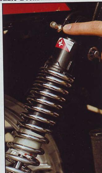
Luftunterstützte und fünffach verstellbare Federbeine
