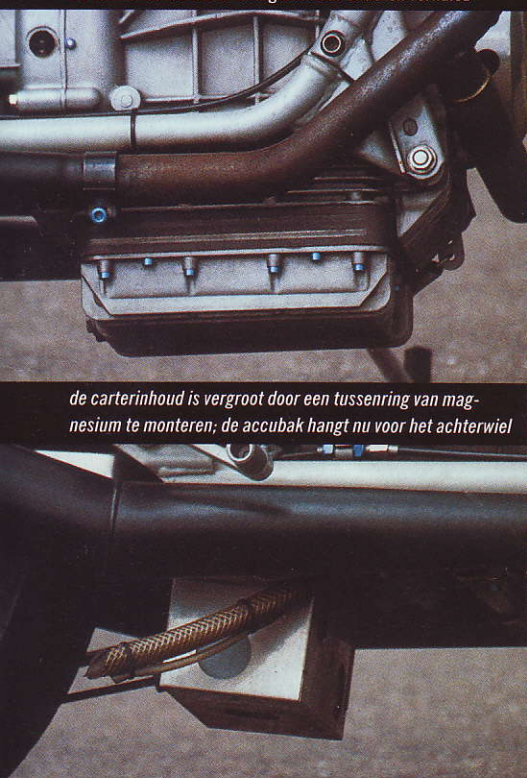
De rem is van boven de swingarm naar onderen verhuisd
