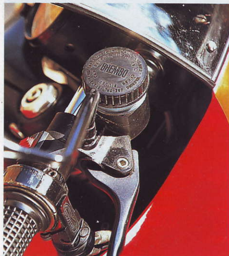
Tomaselli-Gasgriff, durch Dell'Ortos Rückhol-federn drahtig unter Zug, und Brembo-Pumpe, auch damals schon 'was Feines. Stop and go. Beschleunigung und Negativ-Beschleunigung sind als Handbreit nah beieinander
