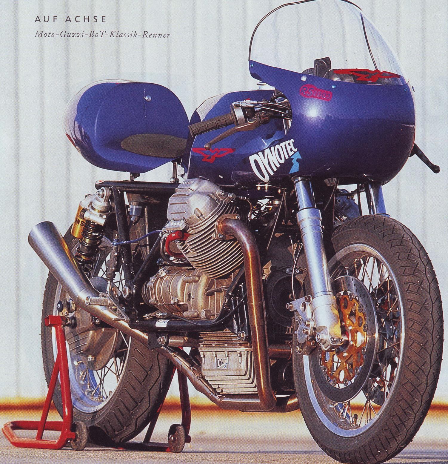
Der mächtige Le Mans 1-Motor mit runden Zylindern und elegant verlegter Megaphon-Auspuffanlage bestimmt die Optik der Klassik-BoT-Guzzi. Hochwertige Öhlins-Federbeine hinten harmonisieren bestens mit der 45er-Telegabel der Honda CBR 900 RR. Die klobigen Brembo-Zangen sind stilecht
