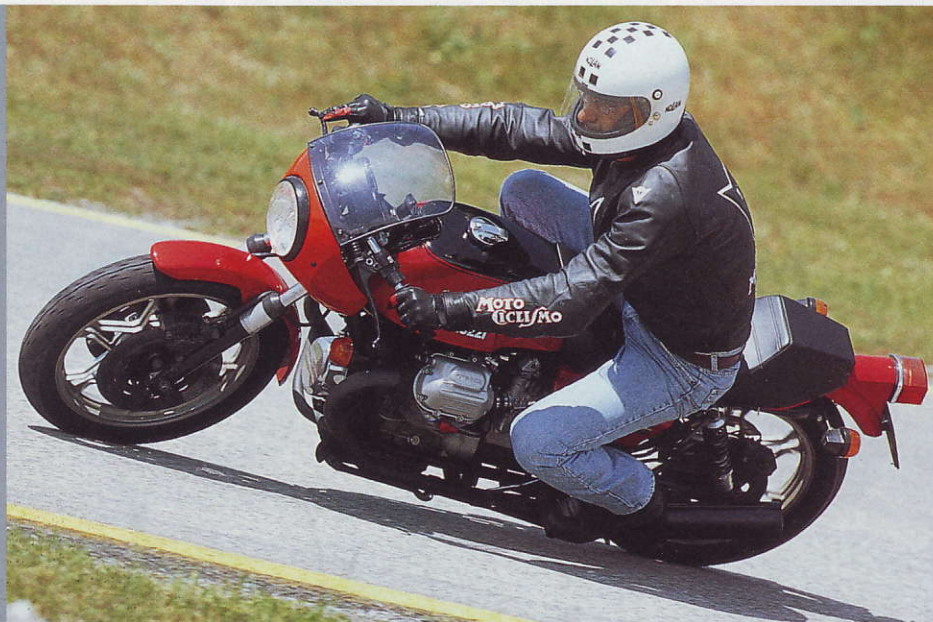
Noch immer flott zu bewegen: Lino Tontis Fahrwerk begeistert noch heute. Nur die Federbeine ersetzte Fabrizio Prat, Besitzer dieser Le Mans, durch modernere Elemente von Koni
