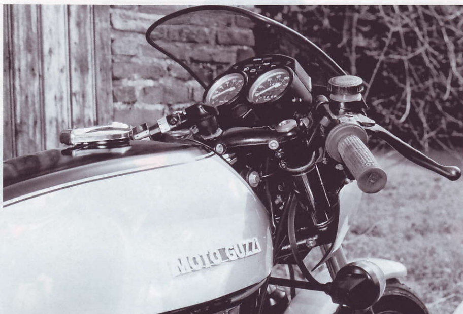
De tankdop van een Le Mans sluit tegengesteld aan die van een V7 Sport! Goed om te weten als u bij restauratie eindelijk een goede tank gevonden denkt te hebben.
