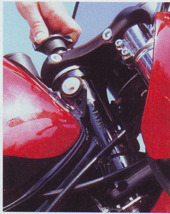
Reibungsverlust: Der Reibungs-dämpfer an der Front beruhigt die Gabel beim Beschleunigen
