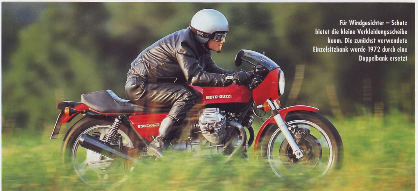
**Für Windgesichter – Schutz bietet die kleine Verkleidungsscheibe kaum. Die zunächst verwendete Einzelsitzbank wurde 1972 durch eine Doppelbank ersetzt**
