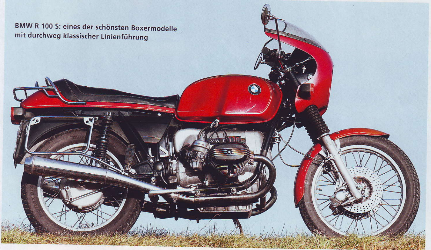
BMW-Telegabel mit vorversetzter Achsaufnahme; schwenkbar gelagerte Bremszangen
