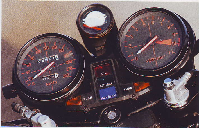
Übersichtlich und präzise: die Honda-Rundinstrumente. Das Voltmeter gehörte nicht zur Serienausstattung
