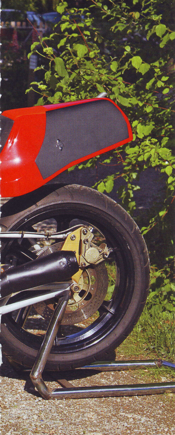
Aufwändig verstrebe Hinterradschwinge mit Unterflur-Federbein. Bremsmoment ebenfalls abgestützt
